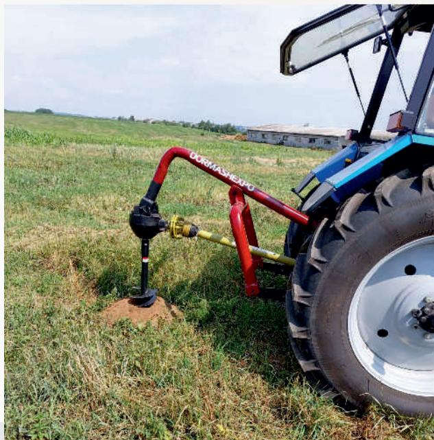
Назначение – для бурения грунтов I-IV категории под установку столбов, стоек ограждений, дорожных знаков, несущих опор, под посадку деревьев и кустарников. Привод бура осуществляется от ВОМ трактора через карданныую передачу, снабженную предохранительной муфтой. Процесс заглубления и подъема рабочего органа осуществляется гидроцилиндром задней навески трактора. Управление навесным ямокопателем осуществляется из кабины базового трактора.
